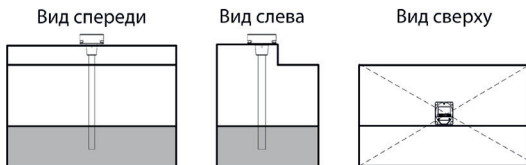
Рисунок 1. Выбор места установки датчика Omnicomm LLS-AF 4
