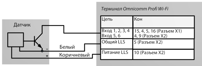
Рисунок 14. Схема подключения датчика с выходом N-P-N типа «открытый коллектор»
