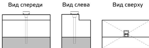
Рисунок 1. Выбор места установки датчика Omnicomm LLS 5
