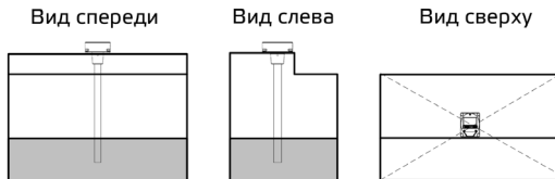
Рисунок 1. Выбор места установки датчика Omnicomm LLS Neo
