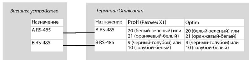
Подключение внешнего устройства по интерфейсу RS-232 к терминалу Omnicomm Profi производите согласно схеме:
