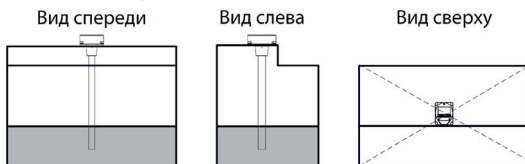
Рисунок 1. Выбор места установки датчика Omnicomm LLS
