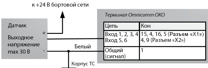
Рисунок 10. Схема подключения аналогового датчика с выходом напряжения (для датчиков, у которых напряжение 24 В входит в диапазон питания)
