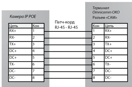
Рисунок 7. Схема подключения видеокамеры
